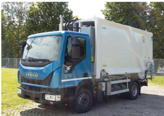
Le camion Iveco Eurocargo 120EL21 fonctionnant au gaz naturel comprimé (GNC) est équipé d'une transmission entièrement automatique Allison 2500™ et d'un mini compacteur Farid PN10.
