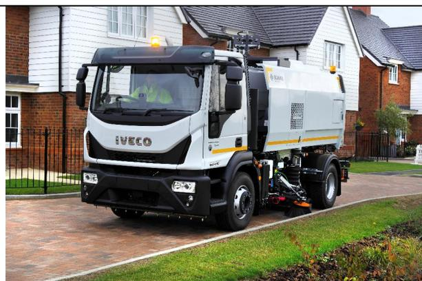
La balayeuse SCARAB MAJOR 5001, montée sur un Eurocargo ML160E21 CNG est équipée de la transmission automatique Allison 3000™, elle sera présentée à Pollutec, sur le stand du Groupe Fayat.
