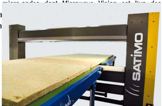
L'imagerie micro-onde, associée à un traitement informatique des données, permet ces contrôles en temps réel. Cette technologie d'une totale innocuité pour l'environnement, évacue toute prise de risque sur la santé des opérateurs, contrairement aux scanners à base de rayon X ou gamma.
