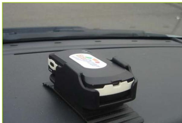
Dans sa première version, l'EcoGyzer est un petit accessoire qui se pose simplement sur le tableau de bord, sans connexion au calculateur du véhicule. L'outil intègre un GPS et un accéléromètre, il enregistre les données cinématiques et dynamiques lors des trajets : kilomètres parcourus, vitesse, accélérations, freinages...
