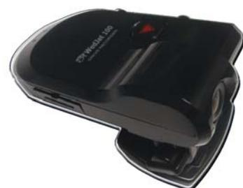
La WedJat, outre un accéléromètre, possède également la fonction GPS. L'antenne est connectée à l'aide d'un jack et peut donc être déconnectée ; de même il est possible d'enregistrer, ou non, le son à l'intérieur du véhicule.
