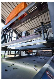
TOMRA_FINDER COLOR 3 : le nouveau système traite des grains de 6 à 120 mm avec un débit pouvant atteindre 20 TPH sur les matériaux Zorba
